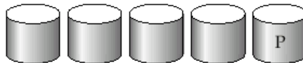
(d) RAID 3: bit-interleaved parity
